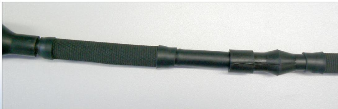
Защита электрожгута от механических воздействий
